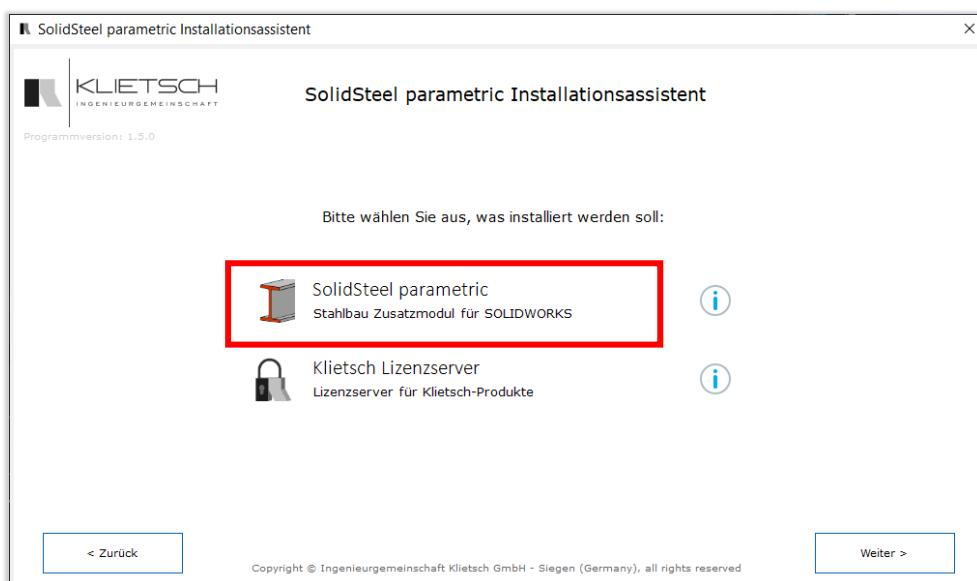
Sollten mehrere SolidWorks Versionen auf dem Rechner installiert sein, erfolgt nun eine Abfrage, für welche SolidWorks Version SolidSteel parametric installiert werden soll. Hier wählen Sie die gewünschte SolidWorks Version mithilfe des Dropdown-Menüs aus:
