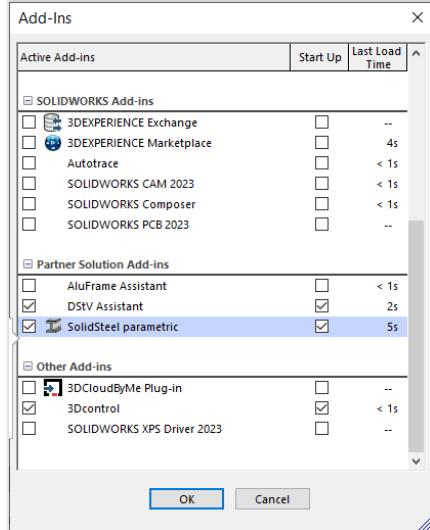
Durch die Installation sollte SolidSteel parametric bereits automatisch mit SolidWorks gestartet werden. Ist dies nicht der Fall, kann es im Zusatzmodul-Fenster von SolidWorks manuell aktiviert werden:
