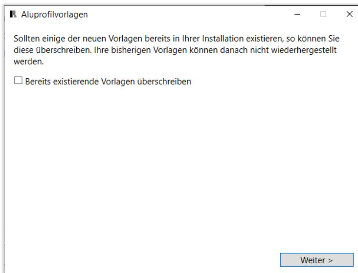
Mit Klick auf weiter startet die Installation der Profildaten automatisch. Ist diese abgeschlossen, kann der Installationsassistent mithilfe „Abschließen“ beendet werden.
