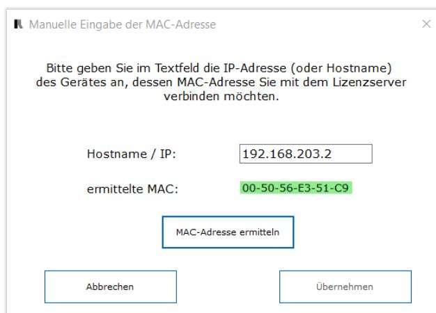
Nach Übernahme der MAC-Adresse gelangen Sie mit „Weiter >“ zum nächsten Schritt. Klicken Sie hier auf „Installieren“, um die Installation abzuschließen. Danach kann entweder die Konfiguration des Lizenzservers oder die Installation der Klietsch Produkte ausgeführt werden.
