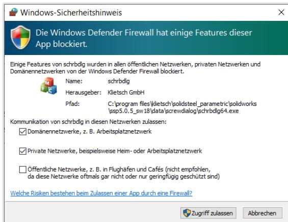
Bei der Windows-Sicherheitsabfrage wird nach Zugriff der Verbindung zu dem Schraubendialog („schrbdlg“) gefragt. Dieser muss seitens des Anwenders zugelassen werden, damit SolidSteel korrekt funktioniert.
