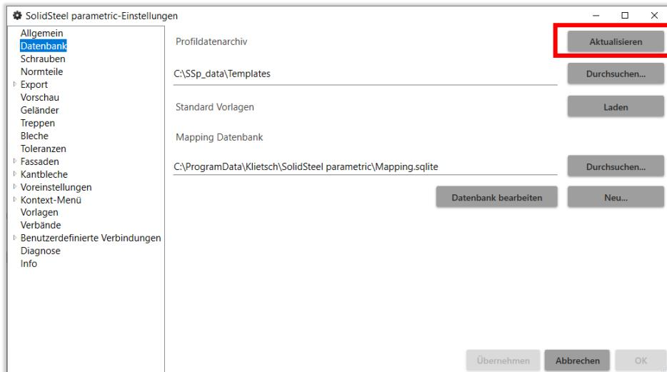
Standardmäßig werden die Profildaten und weitere Vorlagen in [C:\Program Files\Klietsch\SolidSteel\\_parametric\SOLIDWORKS\SSP5.0.5\\_SW23\data\Templates](C:\Program Files\Klietsch\SolidSteel_parametric\SOLIDWORKS\SSP5.0.5_SW23\data\Templates) gespeichert. Die Speicherpfade können beliebig gewählt werden. Serverseitige Vorlagenpfade sind hier ebenfalls möglich.
