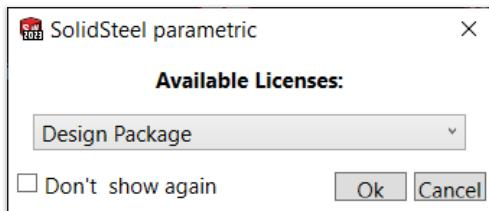
Zusätzlich werden die verfügbaren SolidSteel parametric Lizenzanzeige. Hier kann der Anwender im Dropdown-Menü auswählen, welche verwendet werden soll. Ist dies nicht erwünscht, kann die Abfrage mithilfe des Häkchens bei „Don't show again“ für zukünftige Starts deaktiviert werden.
